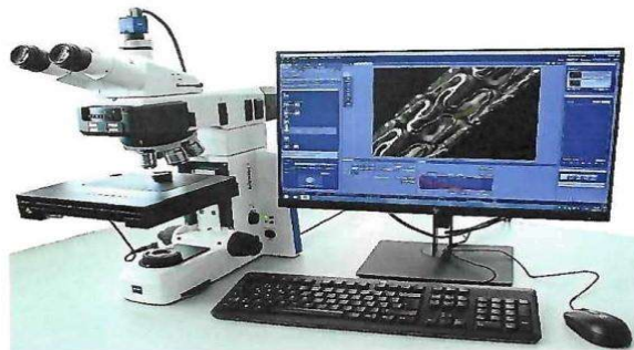
Abb. 3: Optisches Mikroskop Axioscope 7 (Carl Zeiss Microscopy GmbH, Germany) zur Anfertigung von optischen Übersichts- und Detailaufnahmen.
