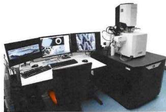
Abb. 4: Rasterelektronenmikroskop Quattro S (Thermo Fisher Scientific Inc., USA) des IIB e.V. zur elektronenmikroskopischen Bildgebung und energiedispersiven Röntgenspektroskopie.
